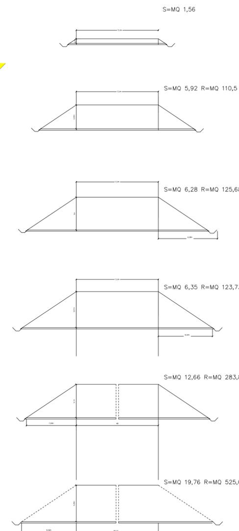
SEZIONI RILEVATO LUNGO LA FERROVIA
